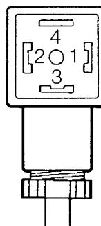
**⚠** 根据现行标准(EN60204 - IEC64-1 - EN60335)，请务必连接地线，如右图所示。
